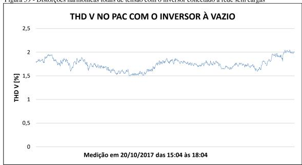
Figura 59 - Distorções harmônicas totais de tensão com o inversor conectado à rede sem cargas
