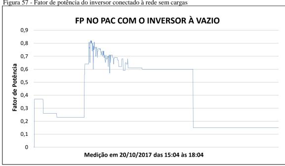
Figura 57 - Fator de potência do inversor conectado à rede sem cargas
