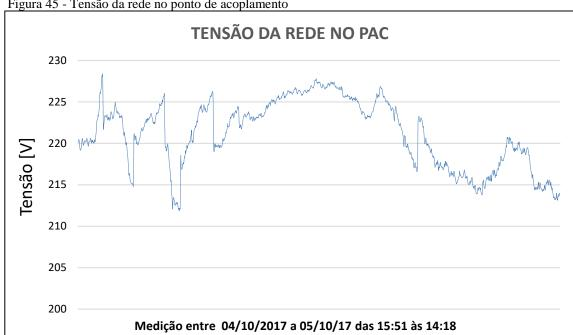
Figura 45 - Tensão da rede no ponto de acoplamento
