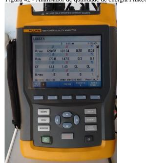
Figura 42 - Analisador de qualidade de energia Fluke® 435
