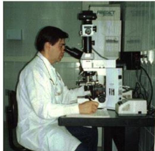
Figura 3 - Ferrograma pronto para o exame e instrumento de análise (ferroscoópio). Fonte: Gestão Estratégica e Técnicas Preditivas, 2002, p. 114.
