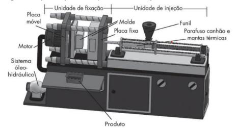
Figura 1 - Representação dos componentes de uma injetora horizontal
