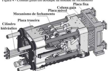
Figura 4 - Colunas guias em destaque na unidade de fechamento
