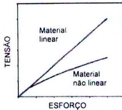
FIGURA 2.13: Gráfico comparativo de materiais lineares e não-lineares. Fonte: FIALHO, 2008.
