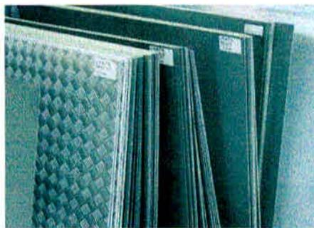
FIGURA 1.2: Chapas Metálicas – Geometria Laminar. Fonte: Gerdau – Linhas de produtos - 2011.
